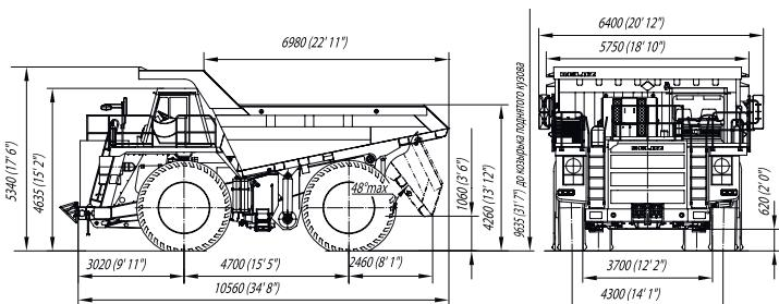
Габаритные размеры указаны для базовой комплектации машины.
