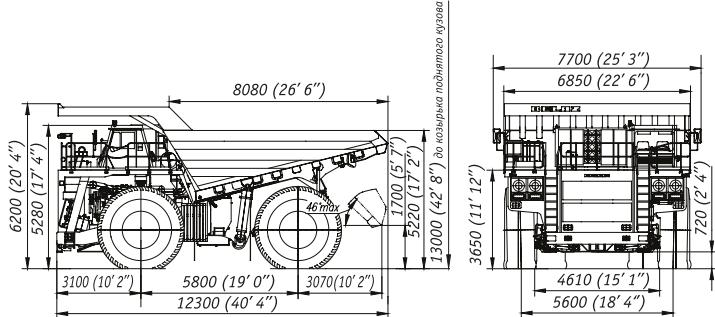
Габаритные размеры указаны для базовой комплектации машин.
