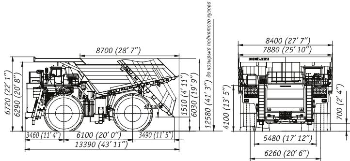
Габаритные размеры указаны для базовой комплектации машин.
