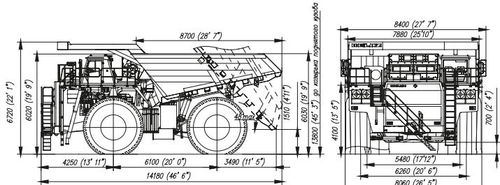
Габаритные размеры указаны для базовой комплектации машин.
