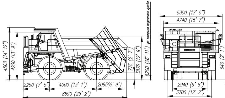
Габаритные размеры указаны для базовой комплектации машин.
