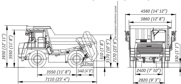
\*Габаритные размеры указаны для базовой комплектации самосвалов
