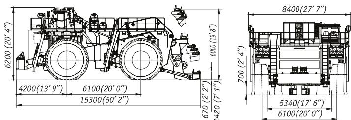
Габаритные размеры указаны для базовой комплектации машины.
