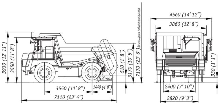
\* Габаритные размеры указаны для базовой комплектации самосвалов
