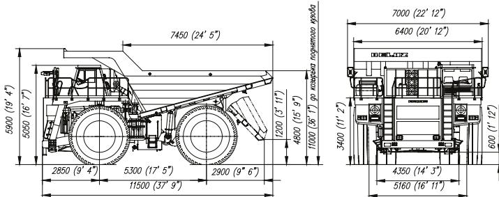
Габаритные размеры указаны для базовой комплектации машин.
