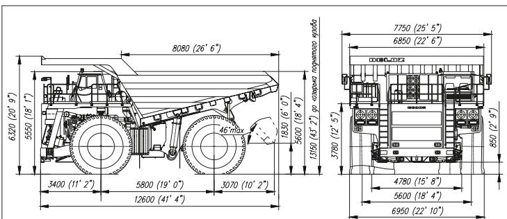
Габаритные размеры указаны для базовой комплектации машин.
