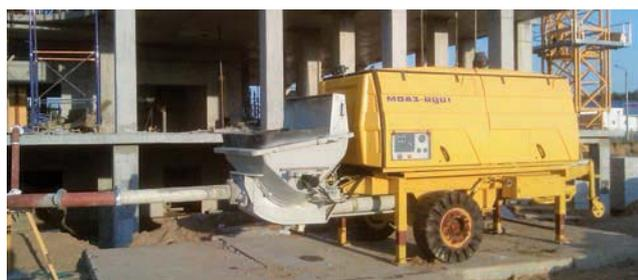
**Стационарно-прицепной бетононасос МоАЗ-8901**
