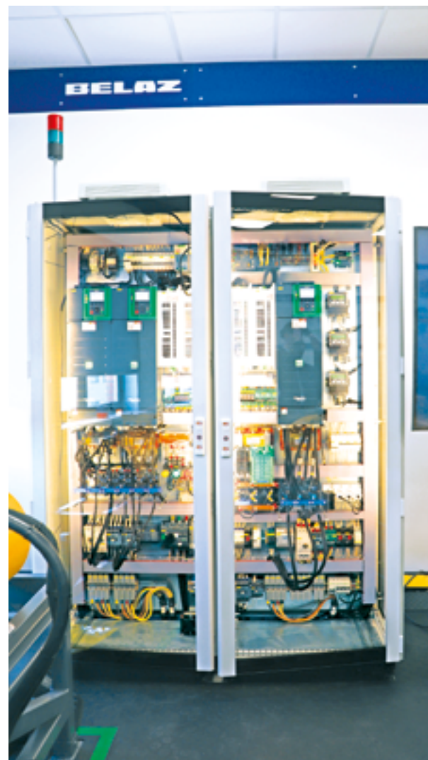
Нагрузочный стенд, имитирующий работу ДВС и мотор-колес
