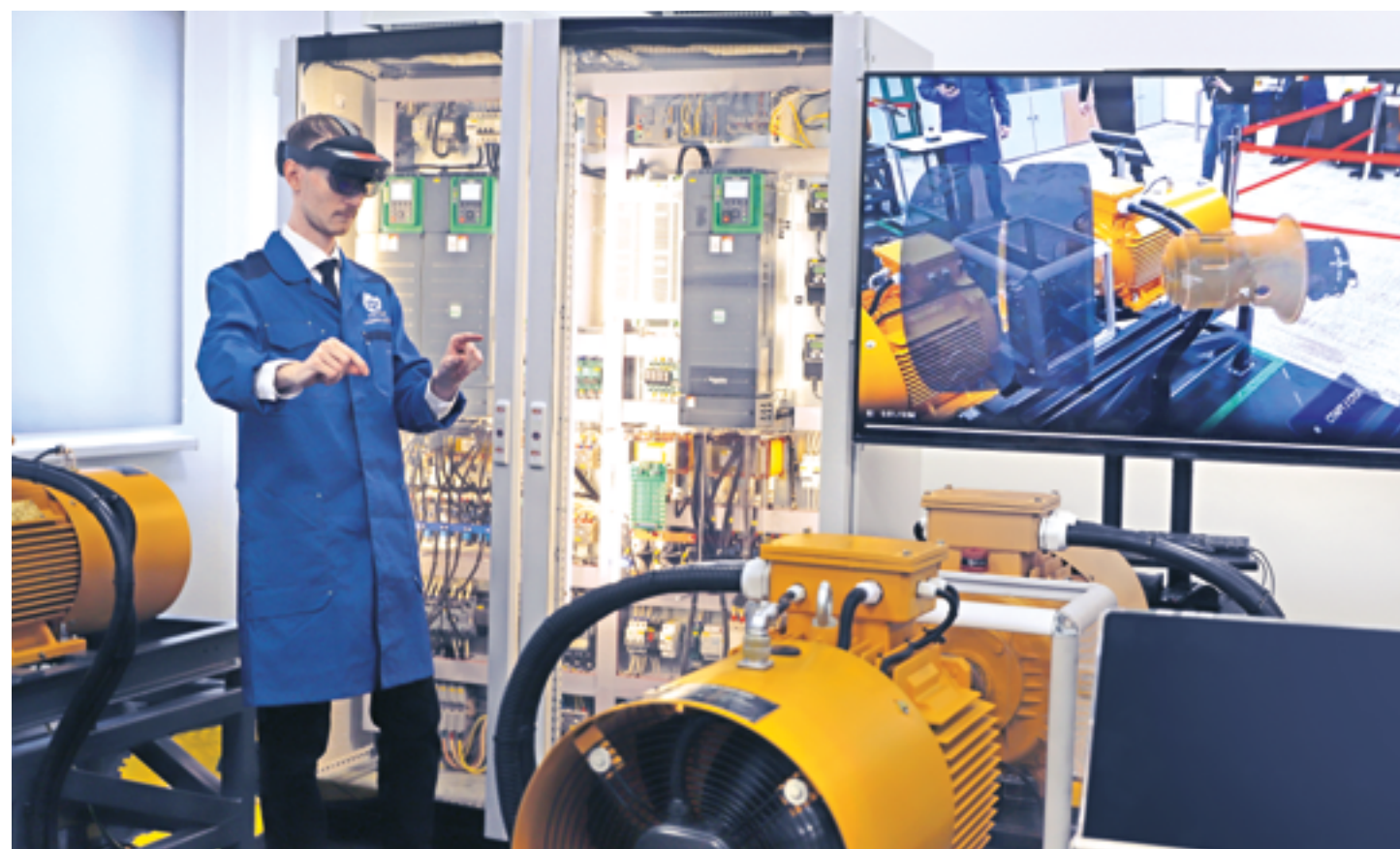
Нагрузочный стенд, имитирующий работу ДВС и мотор-колес
