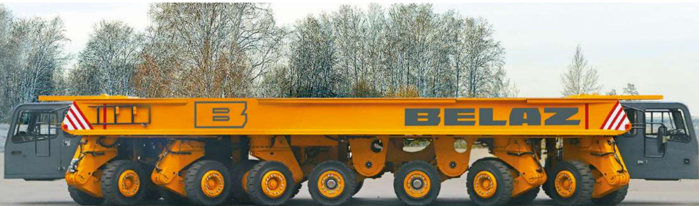
Впрочем, возможность разворота у тяжеловоза БЕЛАЗ-79212 также предусмотрена. Конструкция опирается на 14 колесных модулей с 28-ю цельнолитыми высокоэластичными шинами, имеющими повышенный срок эксплуатации. Стойки пяти из семи рядов колес поворотные, благодаря чему тяжеловоз может развернуться на очень ограниченной площади.
