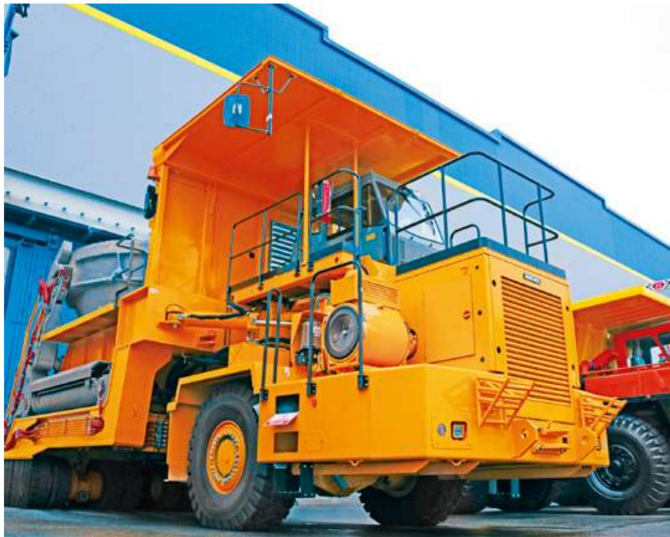
Шлаковоз БЕЛАЗ-79221 – новейшая модель специализированной машины грузоподъемностью 80 тонн, которая оснащена механизмом для захвата и кантования чаши объемом 11 м<sup>3</sup>. В истории производства шлаковозов БЕЛАЗ эта спецмашина стала 22-й по счету среди своих собратьев.
