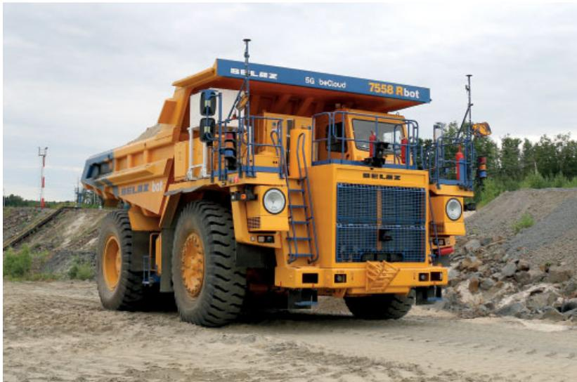
**Рис. 5. Роботизированный карьерный самосвал БЕЛАЗ-7558R грузоподъемностью 90 тонн**
