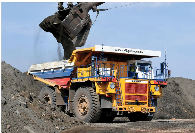
Рис. 4. Роботизированный карьерный самосвал БЕЛАЗ-7513R грузоподъемностью 136 тонн
