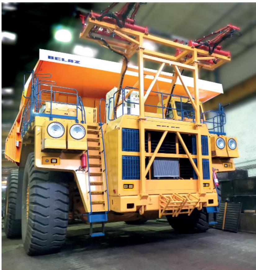
Рис. 9. Дизель-троллейвоз БЕЛАЗ-7530Е грузоподъемностью 220 тонн
