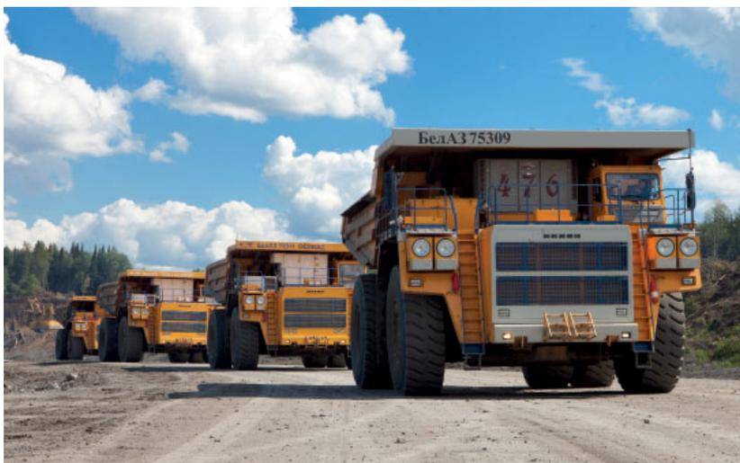
**Рис. 1. Большегрузные карьерные самосвалы БЕЛАЗ грузоподъемностью 220 и 240 тонн в местах эксплуатации**
