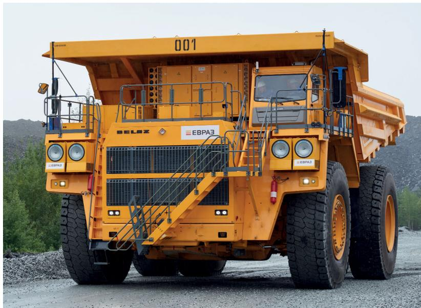
Рис. 2. Карьерный самосвал серии БЕЛАЗ-7531 грузоподъемностью 240 тонн
