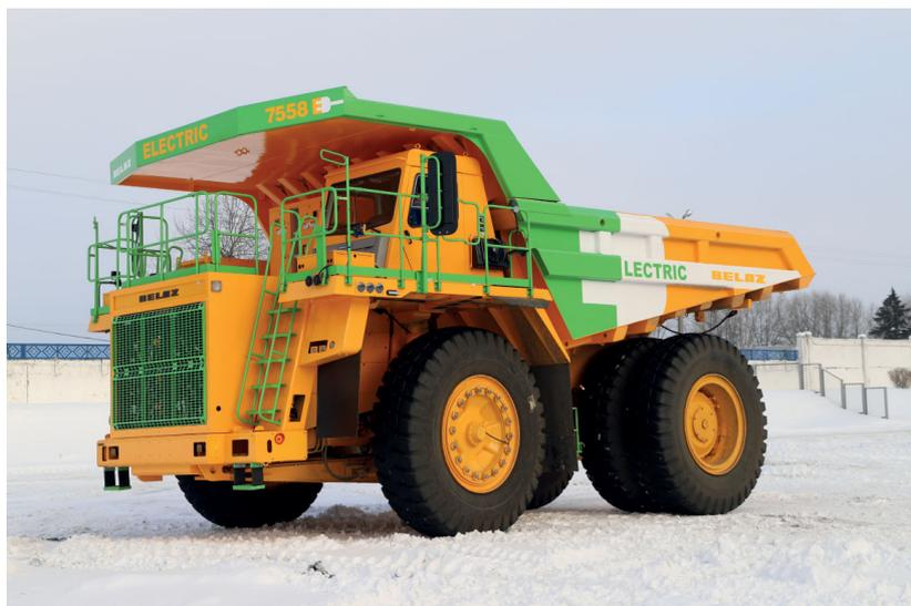
Рис. 11. Карьерный самосвал на аккумуляторных батареях БЕЛАЗ-7558R грузоподъемностью 90 тонн
