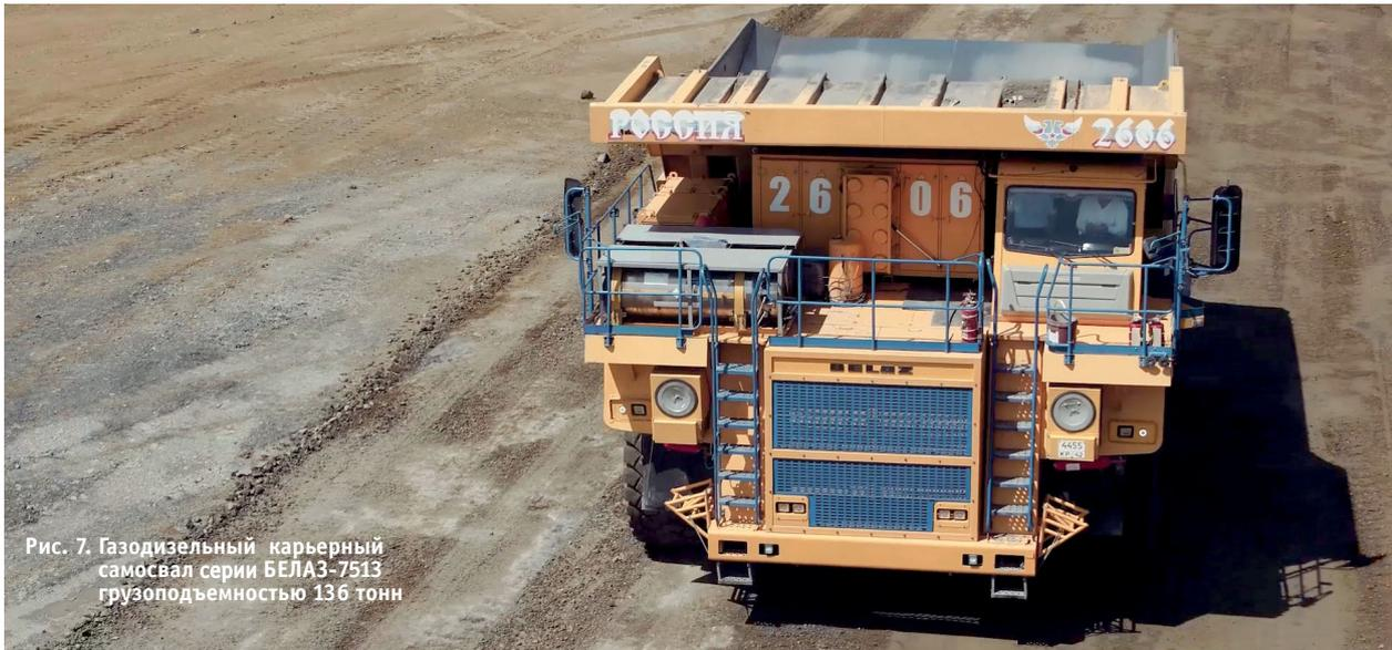
Рис. 7. Газодизельный карьерный самосвал серии БЕЛАЗ-7513 грузоподъемностью 136 тонн
